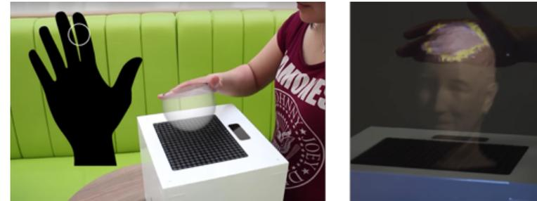
■ **Abbildung 2** Links: Erzeugung eines dreidimensionalen, unsichtbaren Objekts. Rechts: Erzeugung eines unsichtbaren Objekts in Form eines Kopfes. [19]
