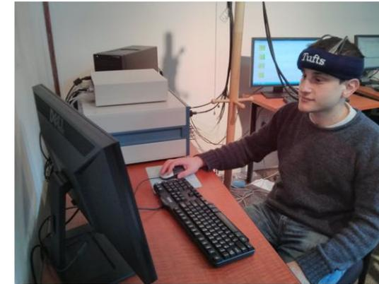
■ **Abbildung 6** Nutzer mit fNIRS-Gerät beim Experiment mit der adaptiven Benutzeroberfläche. (Abbildung: Afergan et al. [2])
