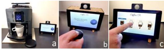
■ **Abbildung 1** Kaffeemaschine, die mit einem personalisierten Druckknopf und einem Berührungsbildschirm bedient werden kann: a) Aufbau des Prototyps; b) Benutzer wird aufgefordert auf den Druckknopf zu drücken; c) Ein benutzerkonfiguriertes Kaffeerezept wird ausgewählt [5]
