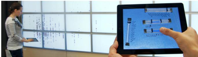
■ **Abbildung 3** Links ist das wandgroße Display mit einer Visualisierung eines Datensatzes. Rechts ist das Tablet mit eigens hergestellten Reglern. Sie steuern dynamische Anfragen die in der Visualisierung sichtbar werden. 1
