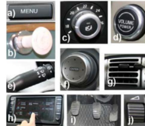
■ **Abbildung 4** Kern & Schmidt haben 8 verschiedene Eingabemöglichkeiten definiert: Knöpfe (a), mechanische Knöpfe (b), kontinuierliche und diskrete Drehknöpfe (c und d), Lenksäulenhebel (e), Multifunktionsregler (f), Schieberegler (g), Touch Displays (h), Pedale (i) und Daumenräder [14].
