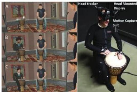
■ **Abbildung 2** Links: Der virtuelle Raum mit den weißen Händen als Grundlage (A) und den beiden verschiedenen Avataren. Rechts: Der Versuchsaufbau und Komponenten des Experiments (aus Paper [11] entnommen)
