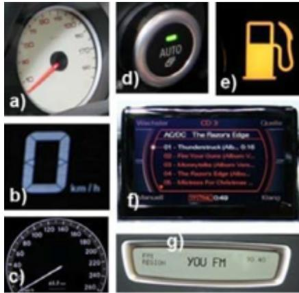
■ **Abbildung 5** Ausgabemöglichkeiten aus [14]: Analoge Geschwindigkeitsanzeige (a), digitale Geschwindigkeitsanzeige (b und c), Anzeigelampe (d), geformte Kontrollleuchte (e), multifunktionaler Display (f) und digitaler Display (g).
