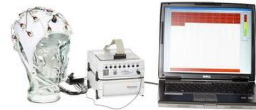
■ **Abbildung 2** Elektrodenkappe, Verstärker und Computer zum Aufzeichnen des EEGs<sup>1</sup>.
