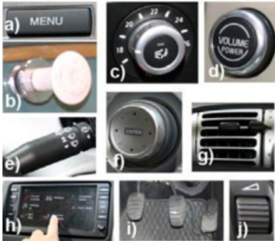
■ **Abbildung 4** Kern & Schmidt haben 8 verschiedene Eingabemöglichkeiten definiert: Knöpfe (a), mechanische Knöpfe (b), kontinuierliche und diskrete Drehknöpfe (c und d), Lenksäulenhebel (e), Multifunktionsregler (f), Schieberregler (g), Touch Displays (h), Pedale (i) und Daumenräder [14].
