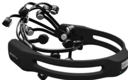
■ **Abbildung 3** Mobiles EEG-Messgerät von *Emotiv*<sup>2</sup>.
