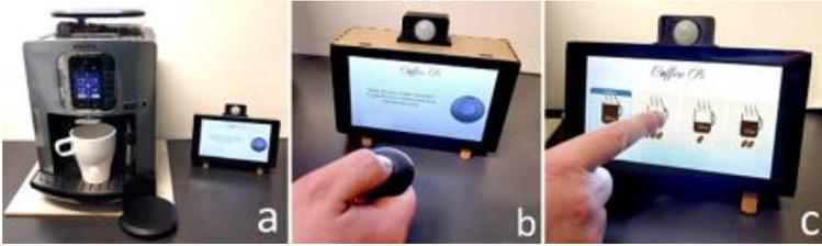
■ **Abbildung 1** Kaffeeemaschine, die mit einem personalisierten Druckknopf und einem Berührungsbildschirm bedient werden kann: a) Aufbau des Prototyps; b) Benutzer wird aufgefordert auf den Druckknopf zu drücken; c) Ein benutzerkonfiguriertes Kaffeerezept wird ausgewählt [5]
